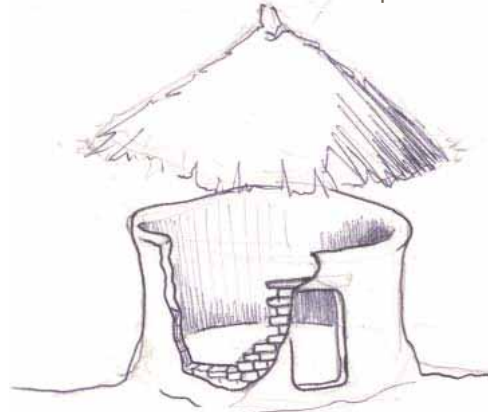
Mise en oeuvre du banco : briques de terre crue
